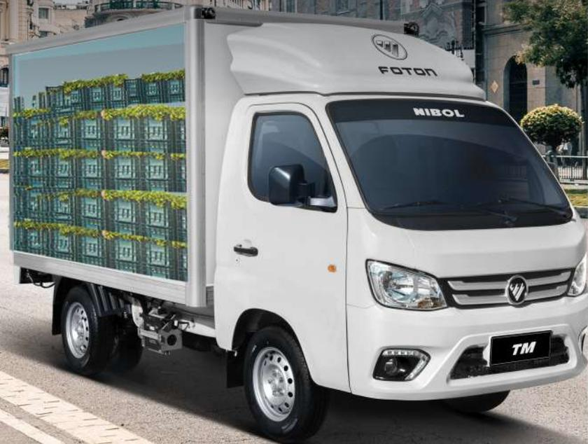
El nuevo modelo de furgón cerrado original de fábrica con alas de gaviota, es el ideal para el transporte de productos de una manera segura. Cuenta con puertas traseras para carga y descarga y puertas laterales que se abren hacia arriba para facilitar la carga, descarga y la venta de los productos. Ofrece un volumen de carga útil de 10m<sup>3</sup>
